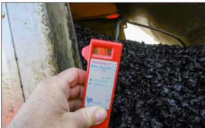
Abbildung 7: Temperaturmessung des Mischgutes bei der Übergabe vom LKW in den Beschickerkübel Quelle: TLBV
