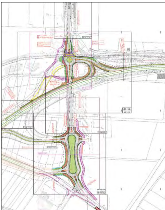
Abbildung 5: Übersichtslageplan Knotenumbau Quelle: TLBV
